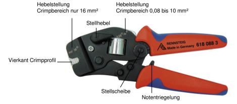
Durch Verstellung der Stellscheibe kann die Crimpkraft eingestellt werden (siehe Punkt "Einstellung der Crimpkraft"). Der Ratschenmechanismus verfügt über Raststufen. Erst nach Überwindung der letzten Raststufe öffnet die Zange selbständig (Prinzip der Zwangsvollendung). Um eine eventuelle Beschädigung von Zange und Verbinder zu vermeiden, kann die Zange über die Notentriegelung bei Fehlercrimpung vorzeitig geöffnet werden.
